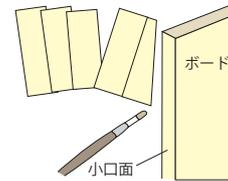
壁間や天井の長さを測り、ボードを仮並べて色・柄のバランス、収まりを確認してください。ボード幅は606mmです。まわりの色・柄と合いにくい場所は目立たない場所にご使用ください。ボードを切断して使用する場合は、小口面をボードと同じ色合いで塗装してください。
