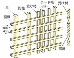
下地材は、図のように組んでください。その時、受け材をボード幅606mmに合わせてください。または、下地材を石膏ボードか合板で仕上げますと、表面を平滑に仕上げられ簡単に施工できます。
