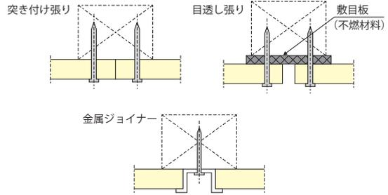
目地は突き付けを原則とします。目透しの場合は不燃材料の敷目板を敷くか、又は金属ジョイナーを使用してください。
